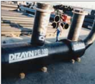
Aliğa Elektrik Santralinde kullanılmak üzere özel olarak üretilmiş ek parça
